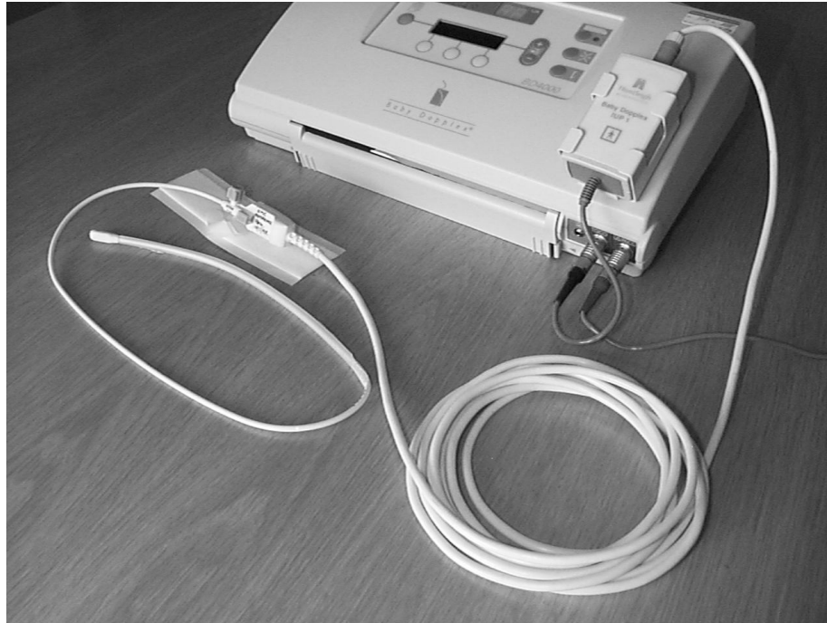
Abbildung 1 - Zeigt das installierte IPU - System mit angeschlossener Sensorspitzen-Sonde
